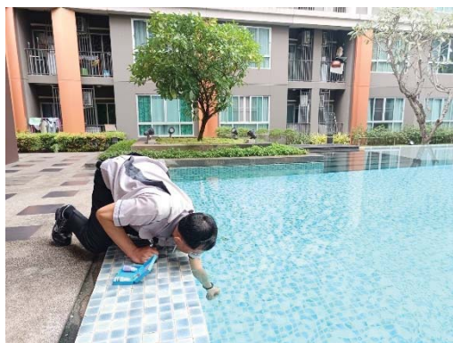
ภาพที่ 3.5.4-1 แสดงการตรวจวัด pH และ Free Chlorine ประจำวัน
