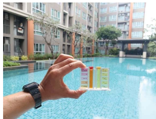
ภาพที่ 3.5.4-1 แสดงการตรวจวัด pH และ Free Chlorine ประจำวัน
